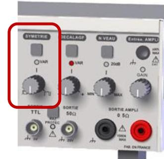
Ce réglage de symétrie est essentiellement utilisé sur les signaux en créneaux et sur les signaux triangulaires :
