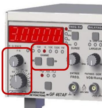
La plage de réglage de la fréquence est très variable selon les modèles de GBF. Les fréquences de travail de ces appareils ont fortement augmenté ces dernières années. Pour cette raison l'appellation Générateur Basses Fréquences est souvent remplacée par Générateur de Signaux ou Générateur de Fonctions.
