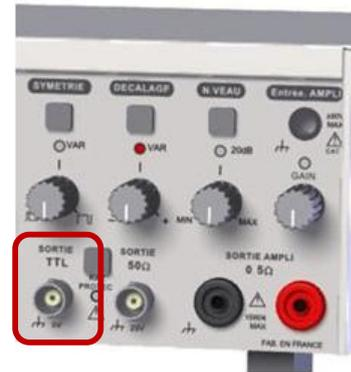
Le réglage de symétrie est actif sur cette sortie. (Le réglage de décalage n'est bien sûr pas opérationnel !)
