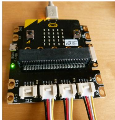
**Remarque : la faible distance entre la carte Micro:Bit et le shield ne permet pas l'utilisation de coques de protection trop encombrantes pour la carte Micro:Bit..**
