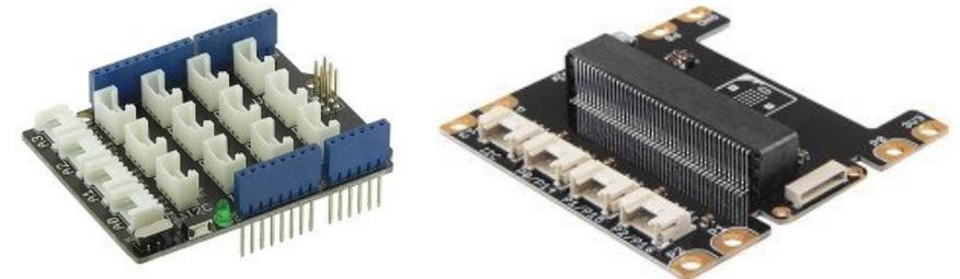
Chacun de ces shields dispose de petits connecteurs qui permettent de connecter différents modules (et il y en a des dizaines différents, de plus à des prix très raisonnables !). Avec ce dispositif, aucune soudure à faire, pas de risque de branchement inversé : la solution la plus simple pour démarrer.
