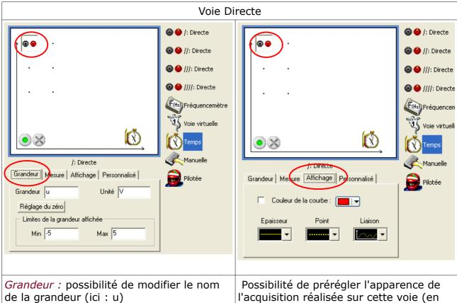
L'étendue de la plage de mesure est rappelée (de -5 à +5 volts sur une entrée directe). Pour avoir d'autres calibres, un adaptateur voltmètre aurait dû être connecté sur cette entrée
